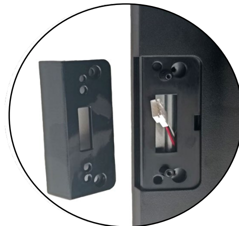
Рисунок 7. Отсек для подключения ридера магнитных карт
